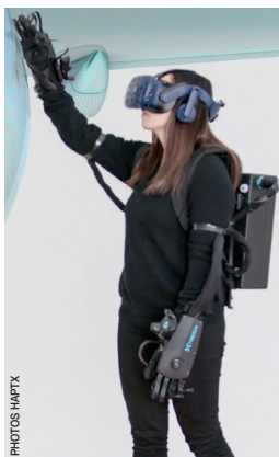
Les gants haptiques DK2 d'HaptX accueillent 133 « actionneurs » par main.
