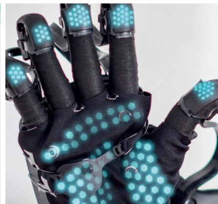
Les gants haptiques DK2 d'HaptX accueillent 133 « actionneurs » par main.
